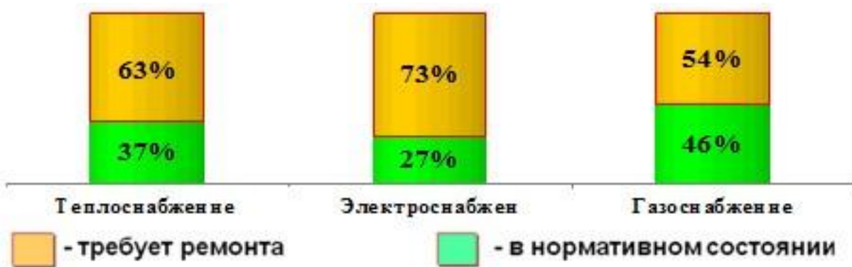
Рисунок 8. Уровень износа инженерных систем в коммунальном секторе Республики Казахстан
