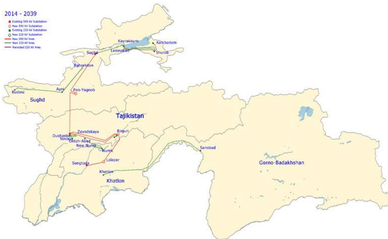
Рисунок 7-5: Рекомендуемые линии электропередачи 500 кВ и 220 кВ для плана с учётом раннего ввода Рогунской ГЭС
