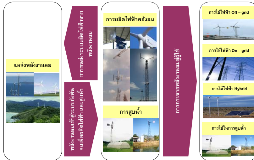
รูปที่ 3-1 ห่วงโซ่อุปทาน (Supply Chain) ของพลังงานลม
