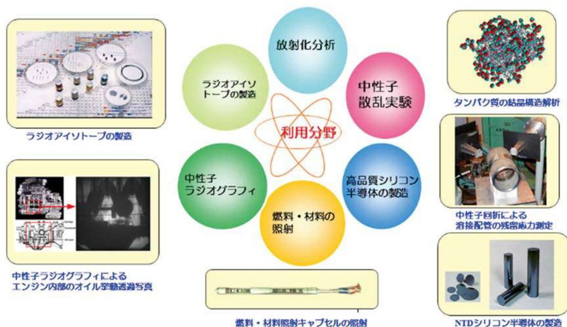
図 7-6 研究用原子炉 JRR-3 での中性子ビームの利用例
