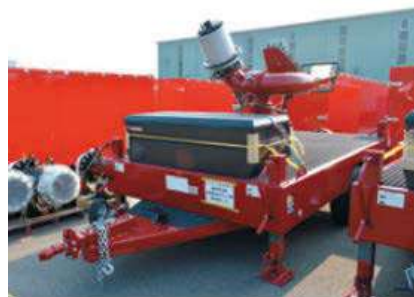
屋外放水設備
